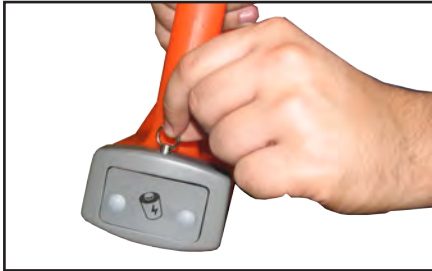
а) Выдвинуть фиксатор, освободить батарейный отсек
