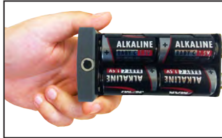
б) Вставить батареи в отсек, соблюдая полярность
