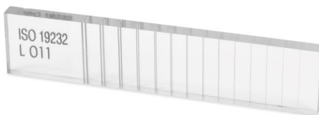
Рисунок 1 - Двухпроводочный эталон Duplex IQI-D17 UHiRes HR4 Kowotest
