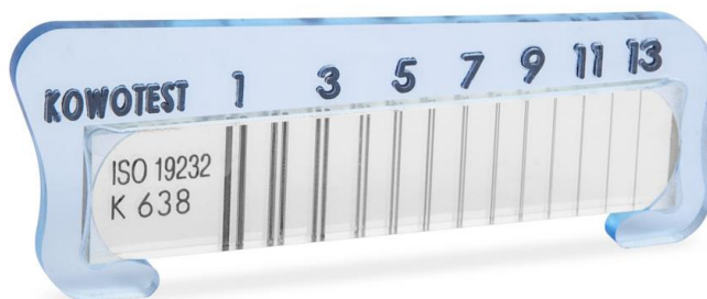
Рисунок 1 - Внешний вид эталона, установленного в скобу
