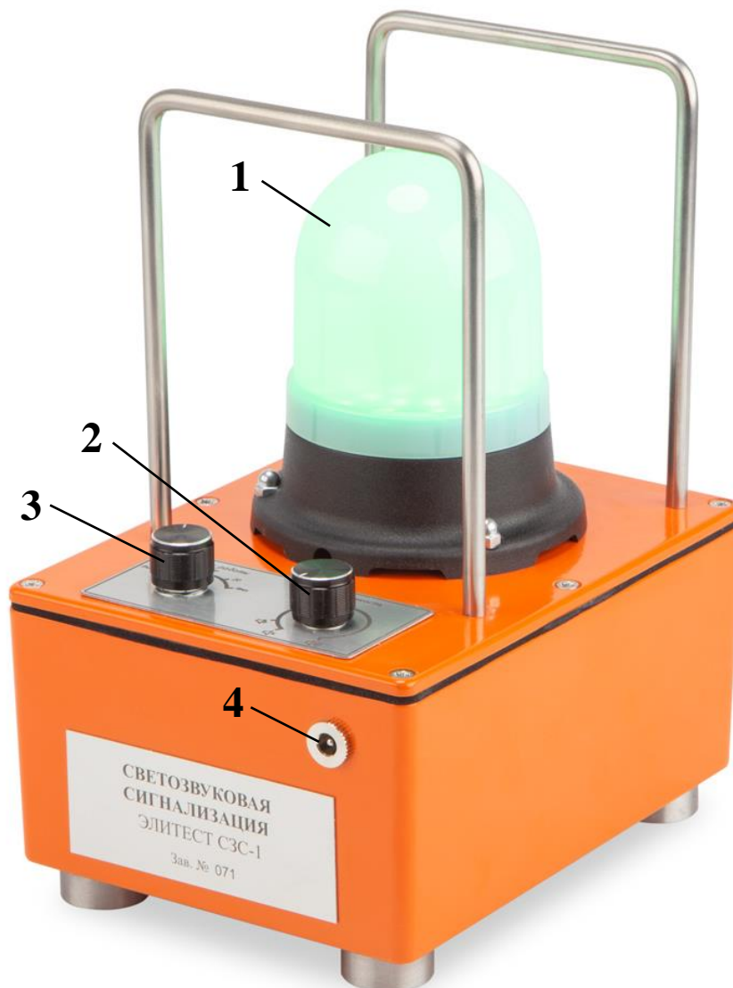
Рисунок 5.1 – Автономная светозвуковая сигнализация ЭЛИТЕСТ СЗС-1
