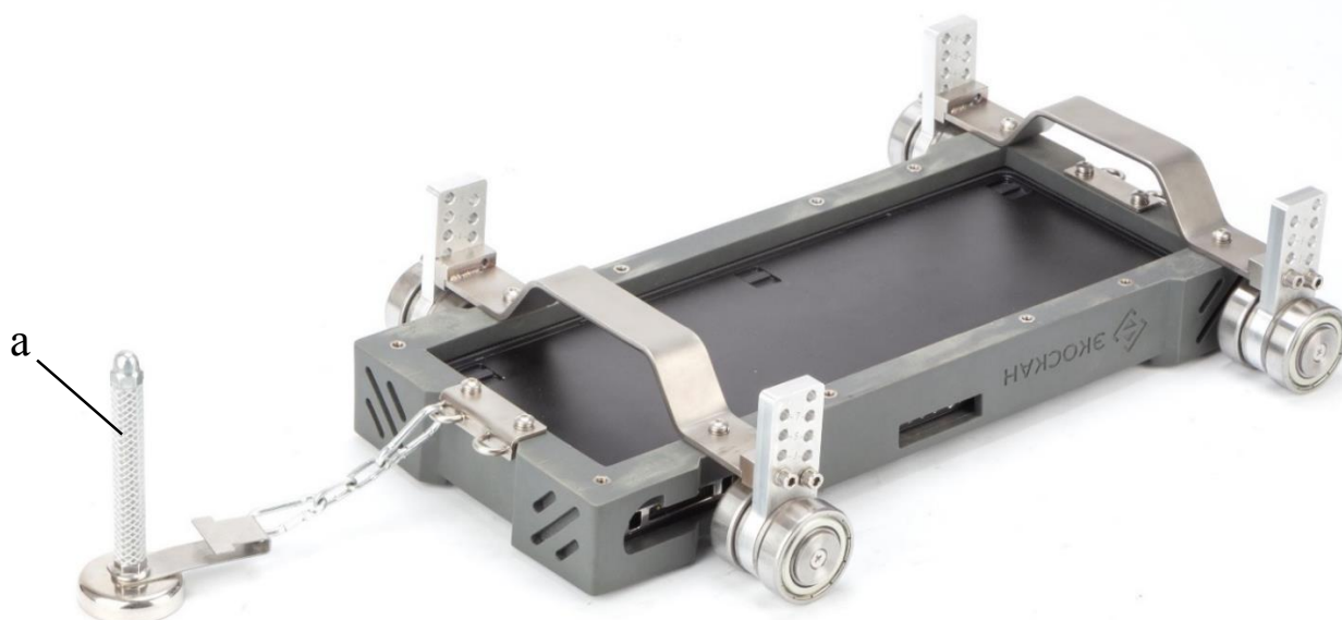
Рисунок 2 – Вариант сборки 1. Длинная колёсная база установки магнитных колёс ЭКО-10МК на защитном кожухе ЭКО-10У а - фиксатор с магнитным основанием (входит в базовую комплектацию комплекса цифровой радиографии Экоскан 10)
